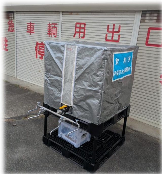
図 3.17 応急給水時に使用する資機材の例(組み立て式給水タンク)
