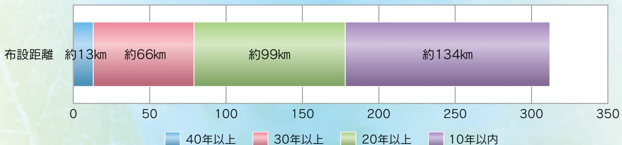
水道施設は昭和40年代後半から増加し、その時代に建設された水道施設が老朽化し取り替えの時期を迎えようとしています。（耐用年数は40年とされています。）それぞれの管の状況によって、全てを直ちに取り替える必要はありませんが、人口の減少に伴い給水収益の大幅な増加が見込まれないなか、管路情報の適切な把握を行い、布設年度や漏水実績等から更新管路の優先度を設定し、計画的な整備を進めていきます。
