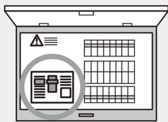
分電盤に内蔵されたセンサーが揺れを感知し、ブレーカーを切って電気を遮断します。
