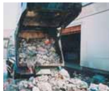
カセットボンベなどが原因とみられる、火災を起こしたごみ収集車
